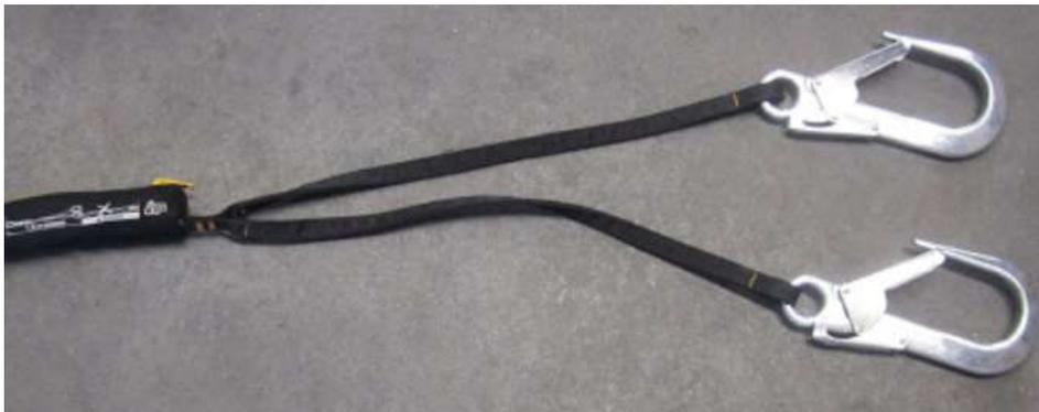
Fig. 3 Elemento de amare de doble cabo
